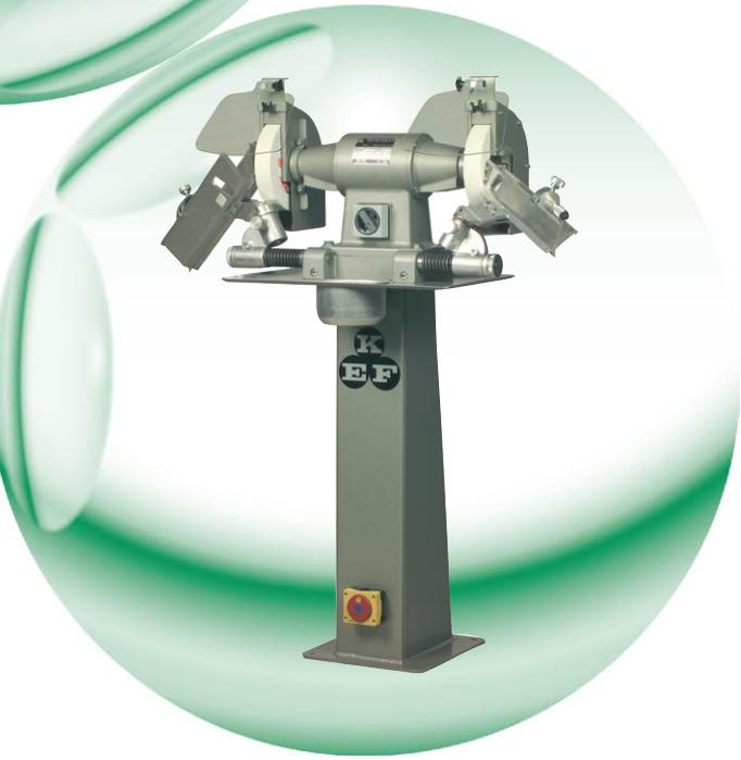
**DK** **Ukompliceret** - KEF borslibeudstyr er forudindstillet til slibning af spiralbor til stål og jern med spidsvinkel 116-118 grader og friskærsvinkel 6-8 grader. Det enkle design gør det muligt at slike en lang række bor af forskellige størrelser uden kompliceret og tidkrævende indstillinger. Top resultater kan opnås af enhver - enkel instruktion medfølger.
