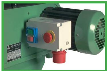
**DK** **Bremsemotor/sikkerhed** - Alle industribåndslibere leveres med bremsemotor, hvor båndet standser efter 3-5 sec. når motoren slukkes.
