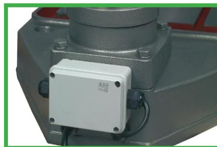
**DK** Separat tilslutningsdåse for kølepumpe og hoved strømforsyning
