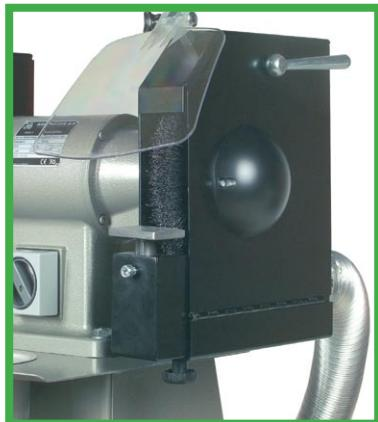
**DK** Viste maskine er komplet med indbygget udsgning i søjle med bord og vandkop.
