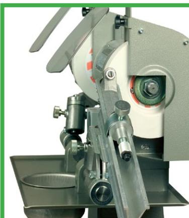
**DK** For at opnå det bedst mulige resultat ved slibning af bor, skal kopskiven være helt plan. Derfor skal denne med mellemrum afrettes. Til dette medfølger en afretterdiamant med holder. Denne lægges i borslibearmen. Ved at følge brugsanvisningen afrettes kopstenen, så den bliver helt plan igen i løbet af få sekunder. Diamant og holder er standardtilbehør.
