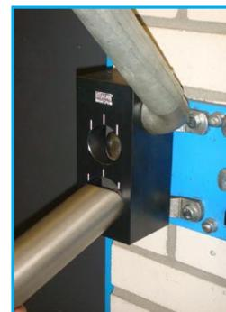
**DK** ALMI rørudklinkere kan benyttes alle steder hvor gas-, damp-, rustfri-, ikke-jernholdigerør samt mange andre rør og profiler skal svejses sammen i en vinkel af 90°. ALMI rørudklinkere udklinker hurtigt og præcis og er desuden ideel til fremstilling af dobbelt hjørne-samlinger.
