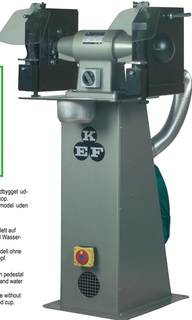
**DK** KEF professionelle afgratere er opbyggede over KEF Motor's kraftfulde kvalitets motorer. Alle maskiner tilbydes med og uden udsugning eller forberedt til et eksisterende centraludsugningsanlæg. Ideal for både mindre værksteder som industri.
