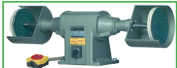
**DK** Polermaskine POD 8 - koniske spindler, 2 Hastigheder 1400 + 2800 omdrejninger. Polerskiver i 200 mm ø. Tilbydes også på udsugningssøje EX 16
