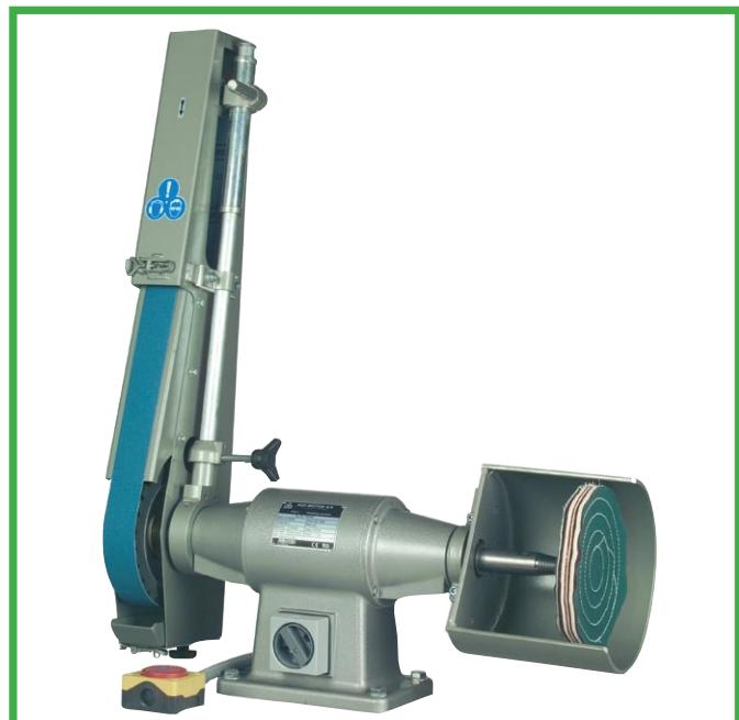
**DK** Bordmodel med spindel -Polerarm 50x1600 mm
