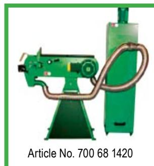
**DK** Komplet udsugnings- og filterenhed med cykロン, udsugning, opsamlings-skuffe og afgangsfilter
