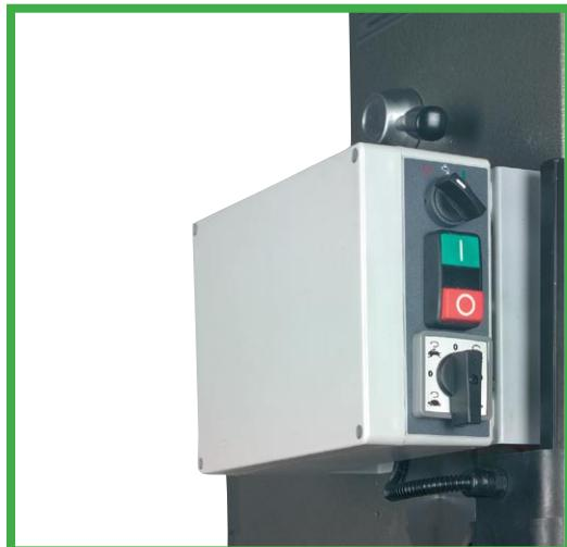
**DK** Betjeningspanel med afbrydere for tænd og sluk, høj og lav hastighed samt kølevæske
