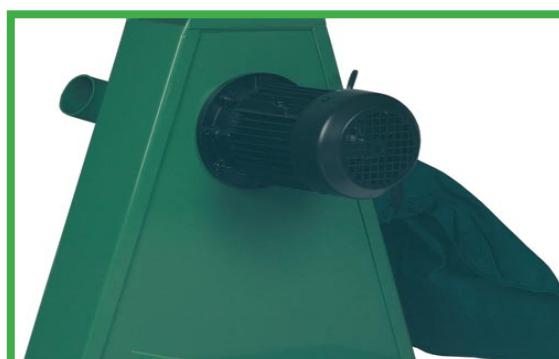
**DK** **Udsugningspose** - Som standard leveres alle indbyggede udsugningsanlæg med udsugningspose. Denne skal, som en støvsugerpose, tømmes ofte og grundigt for at opnå den bedst mulige udsugning.
