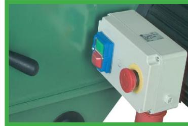
**DK** **Nulspændingsrelæ** - med indbygget nødstop og elektronisk bremse giver stor sikkerhed.
