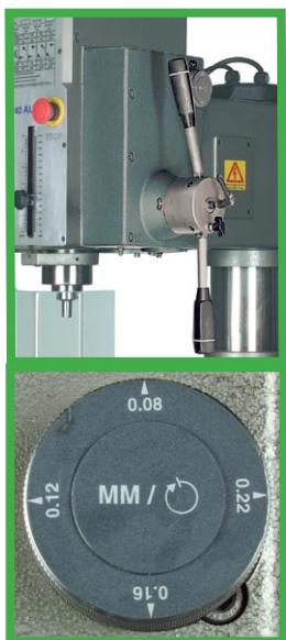
**DK** Samme maskine kan også leveres med automatisk tilspænding - KEF SB 35 AUT.
