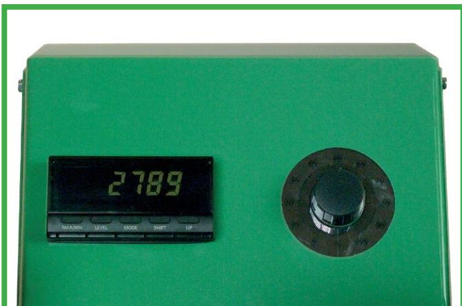
**DK** Polermaskine **Polette 8 NE** Regulerbar hastighed med digital visning 0 - 4000 omdrejninger. Fås også på udsugningssøje EX 16 Polerskiver i 200 mm ø .
