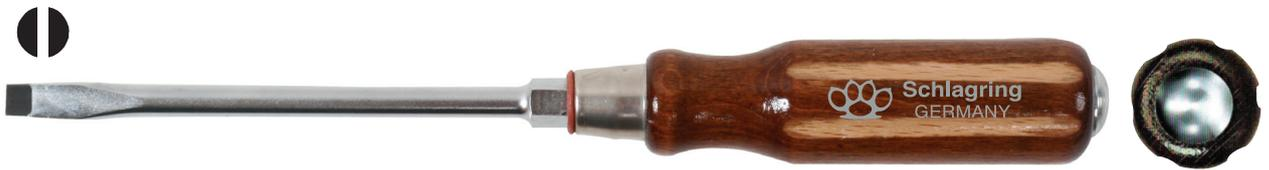
**Schlagring-Kraftschraubendreher** mit festem Sechskantsatz nach DIN 475. Durchgehende Klinge aus Spezial-Stahl, ganz gehärtet und vernickelt, mit extra großer Schlagplatte, Heft braun poliert
