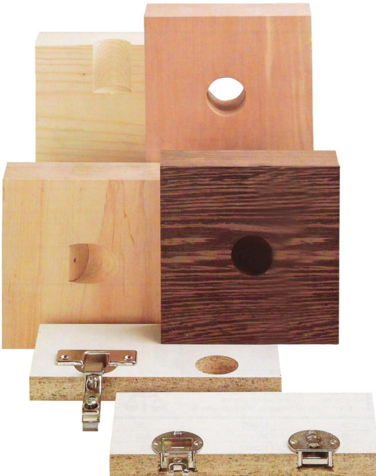
Der Schlagring-Gold-Star arbeitet wie ein Forstnerbohrer : auch halbe und schräge Bohrungen sind kein Problem. Er verbindet alle Vorteile eines Forstnerbohrers mit denen eines HM-bestückten Kunstbohrers. Darüber hinaus bietet die automatische Spandickenbegrenzung erhöhte Sicherheit und die Schrägstellung der Hauptschneiden gewährleistet eine besonders leichte Arbeitsweise
