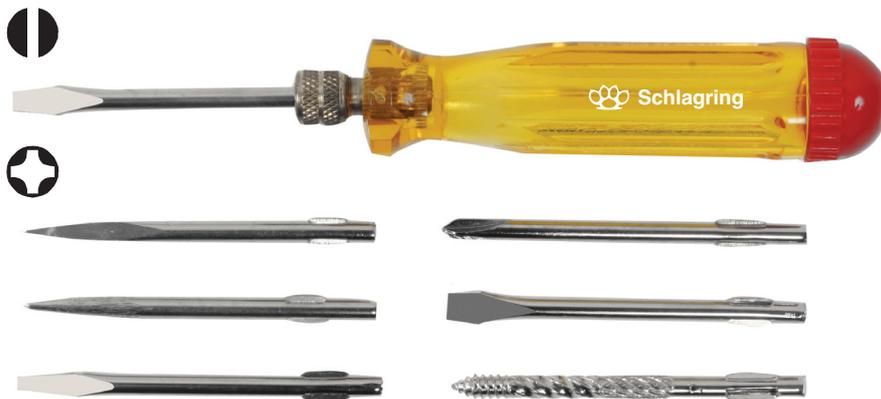
**Schlagring-Werkzeugbüchse.** Große, handliche Ausführung mit kräftigem Vierbacken-Messingspannfutter, 7 vernickelten Klingen 4,5 x 65 mm und Schraubverschluss. Alle Klingen werden im Heft aufbewahrt
